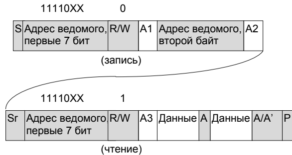
Рис. 6.15. Ведущий приемник адресует ведомый передатчик с 10-битным адресом
