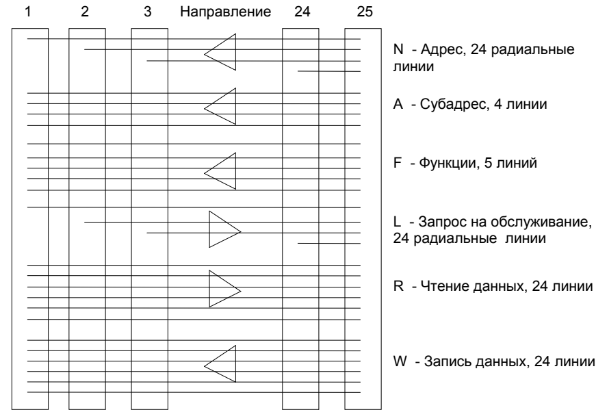
Рис. 4.3. Основные шины горизонтальной магистрали
