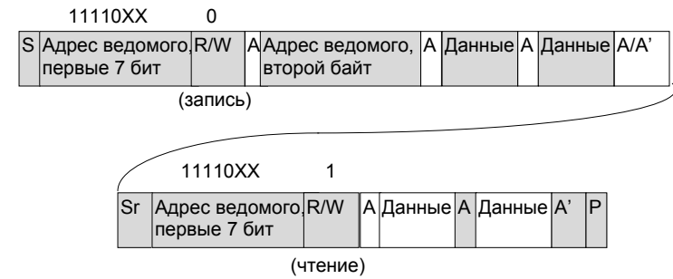
Рис. 6.16. Комбинированный формат. Ведущий адресует ведомое устройство с 10-битным адресом, а затем передает данные ему и читает данные от него
