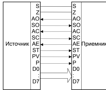
Рис. 5.2. Структура связей между источником и приемником сообщений
