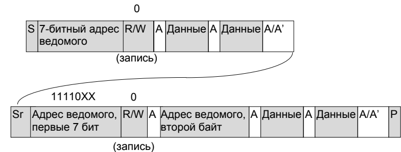
Рис. 6.18. Комбинированный формат. Ведущий передает данные двум ведомым устройствам: одному с 7-битным адресом, другому с 10-битным адресом
