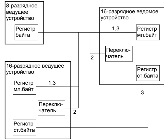
Рис. 6.2. Передача данных по информационным линиям: 1 - передача младшего (четного) байта; 2 - передача старшего (нечетного) байта; 3 - передача 16-разрядного слова
