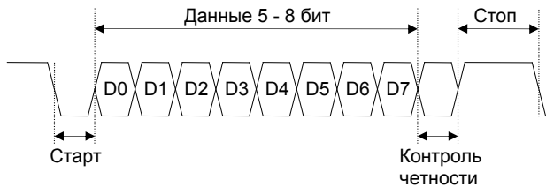
Рис. 5.5. Формат кадра передаваемой информации
